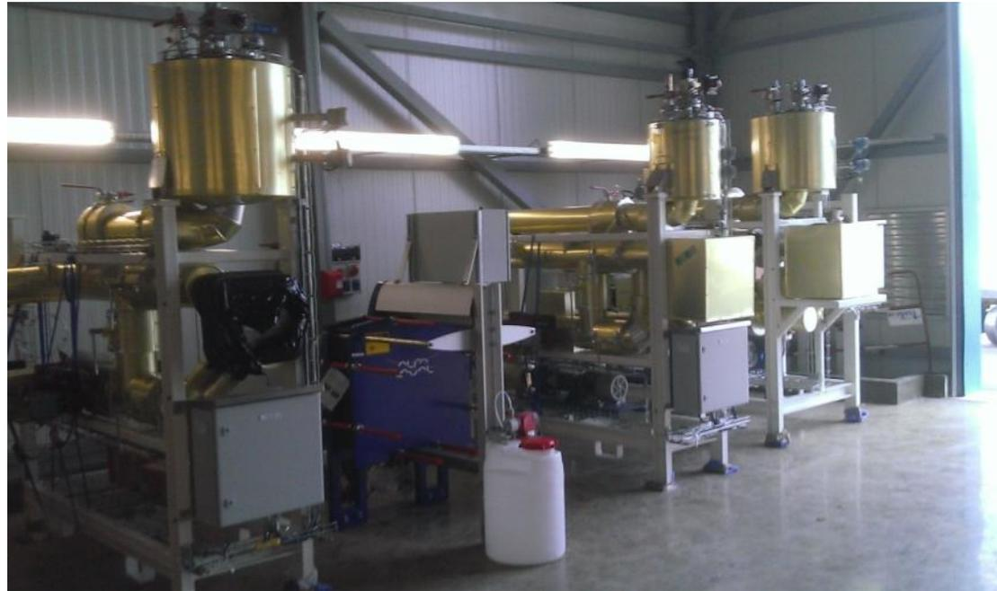
Machine de dessalement MED et skid de distribution de chaleur Multitherme
